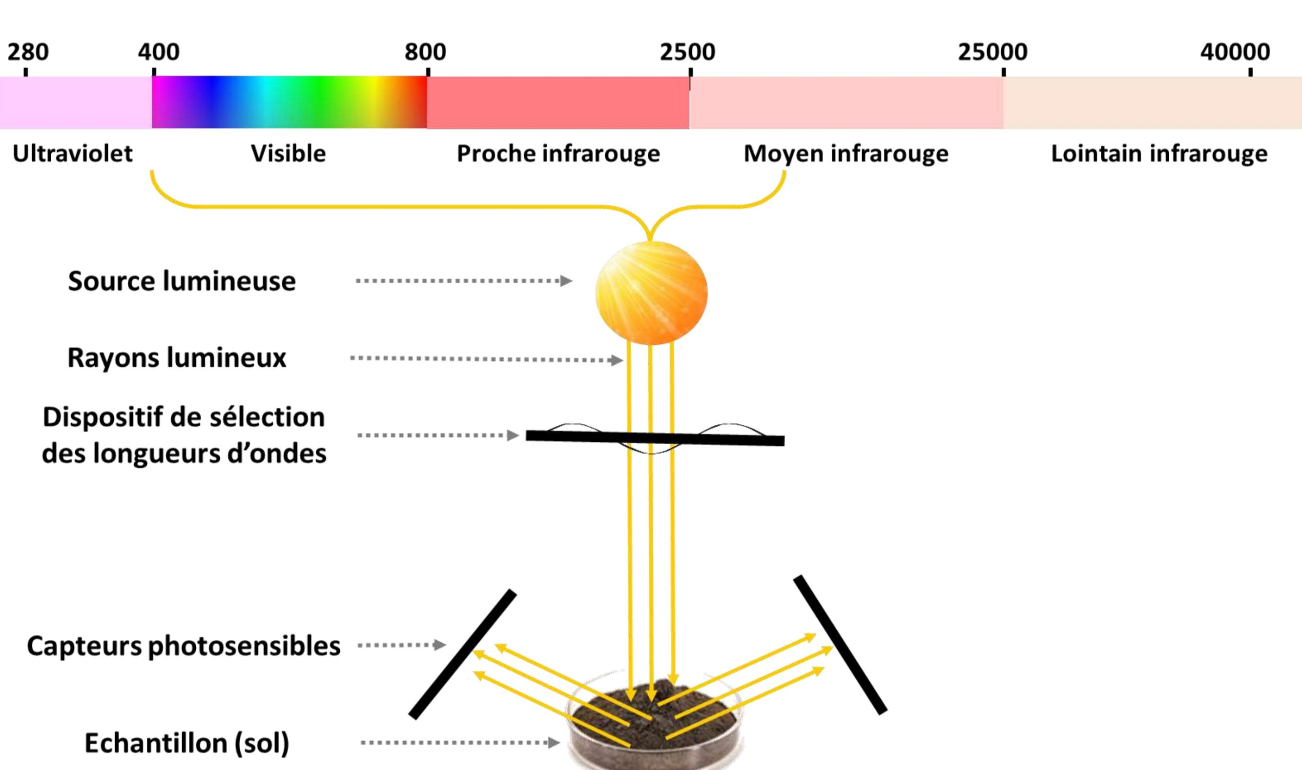
Illustration du principe de la spectroscopie
